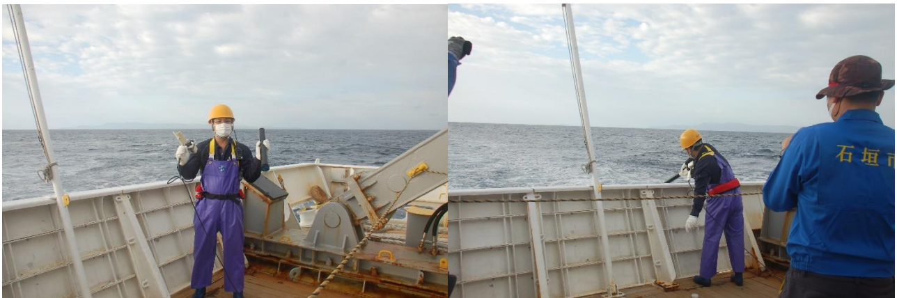
水温・塩分の鉛直プロファイルを観測する XCTD センサーと投入風景
