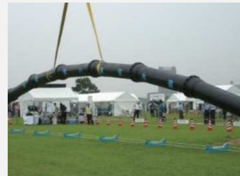
〔耐震継手管の吊り上げ実験〕
