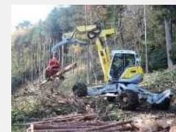
[4輪多関節型作業機械 スパイダーによる造材]
