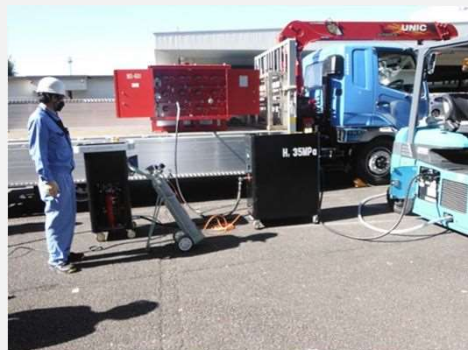
〔水素ガスカードル、簡易水素充填機、燃料電池フォークリフトを接続している様子〕
