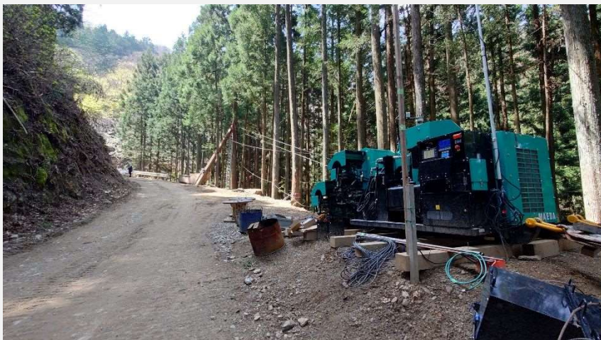
〔林業経営体へ貸与した無線ラジコンを使用する油圧式集材機 (檜原村)〕
