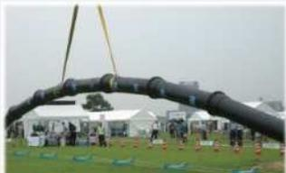
〔耐震継手管の吊り上げ実験〕
