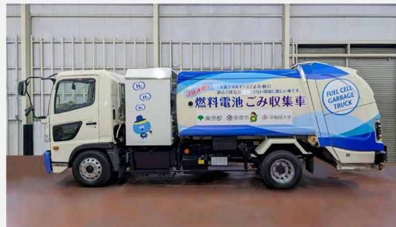
〔燃料電池ごみ収集車（試験運用車両）〕
