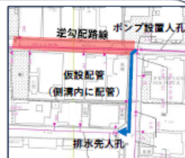
図1：仮設配管の状況図
