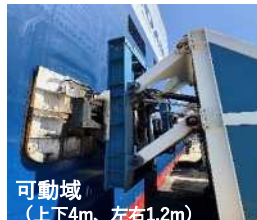
無線により自動で接岸位置を調整
