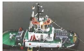
水素混焼船（Hydrotug1）
