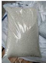
左写真のプラスチックを高度選別・洗浄して製造した再生原料→
