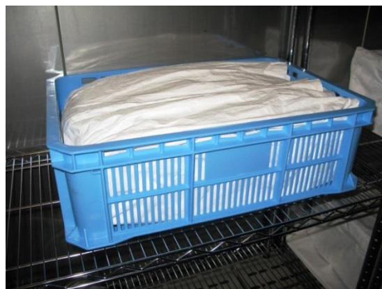
図 42 不織布の包み込みによる梱包 ・デュポン社のソフトタイベックを使用 ・規格は厚さ 0.14mm×幅 1,016mm
