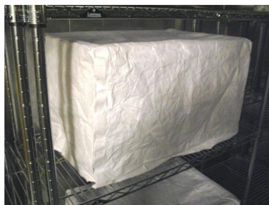
図 42 不織布の包み込みによる梱包 ・デュポン社のソフトタイベックを使用 ・規格は厚さ 0.14mm×幅 1,016mm
