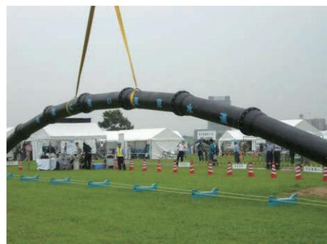
耐震継手を有するダクタイル鋳鉄管
