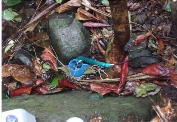
水質計（pH計）の設置、計測状況
