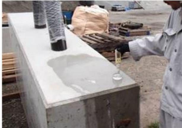
工場打設したコンクリートのpH測定状況
