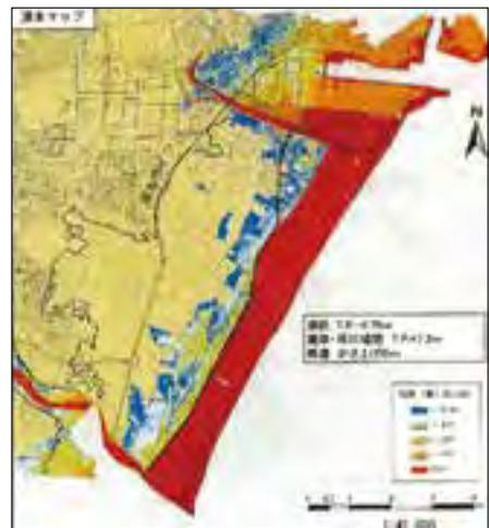
図1：津波浸水シミュレーション
