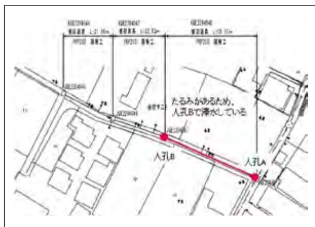
震災直後には異常が見られなかったが、 付近の汚水量が増加し被災が判明した路線
