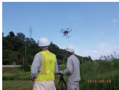
ドローンを使用したモニタリング状況
