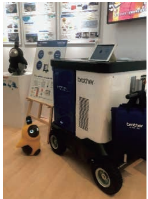
可搬式燃料電池からロボットへの給電
