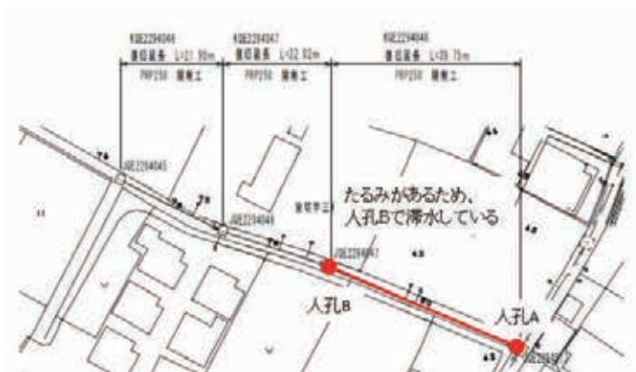
震災直後は異常が見られなかったが、付近の汚水量が増加し被災が判明した路線
