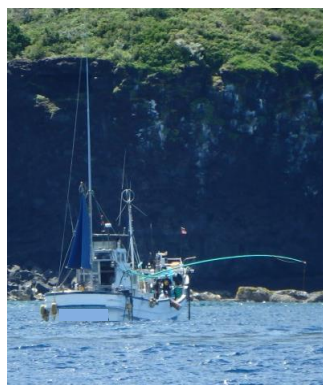
↑ 作業中のムロアジ漁船 右手に伸びる棒の水面下に網をたらし、その上に餌で魚をおびき寄せる。
