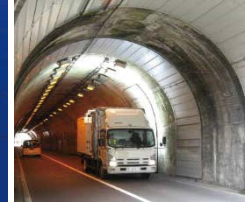
トンネル内の変形を自動計測できる点検車
