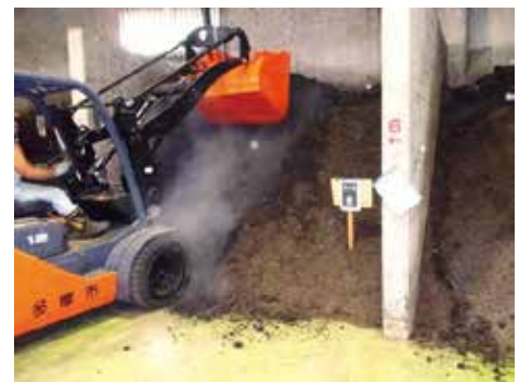
土壌改良材を攪拌している様子
